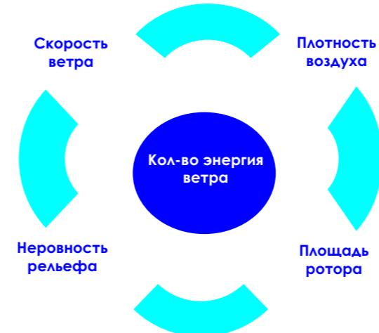
Рис.3 Зависимость количества энергии ветра от различных факторов
