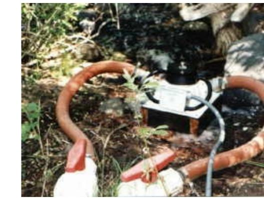
Рис.1 НаноГЭС с генератором на постоянных магнитах
